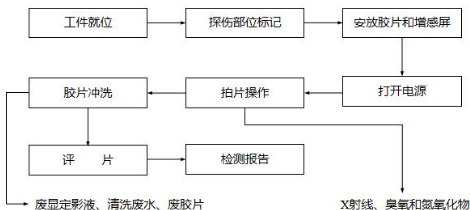
图 9-6 X 射线探伤机室内探伤工艺流程图及产污位置图
