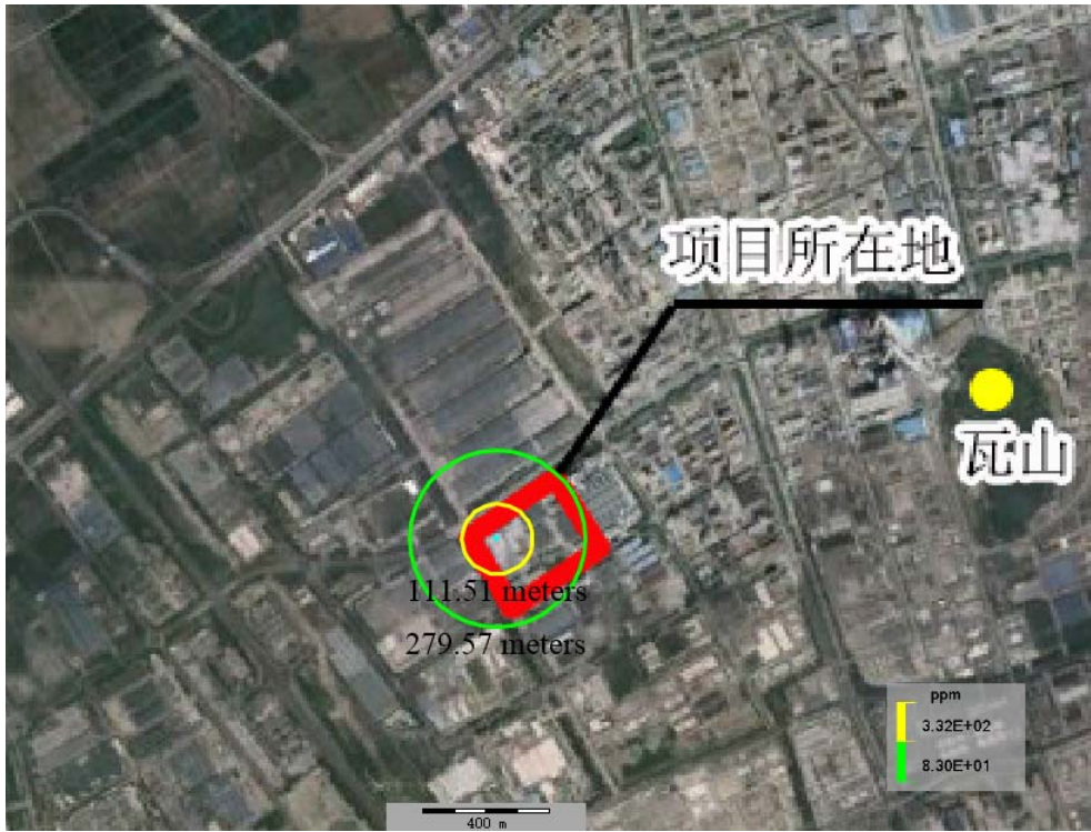
图 6.8-20 环氧乙烷球罐泄漏引发火灾事故最不利气象条件下 CO 扩散预测结果
