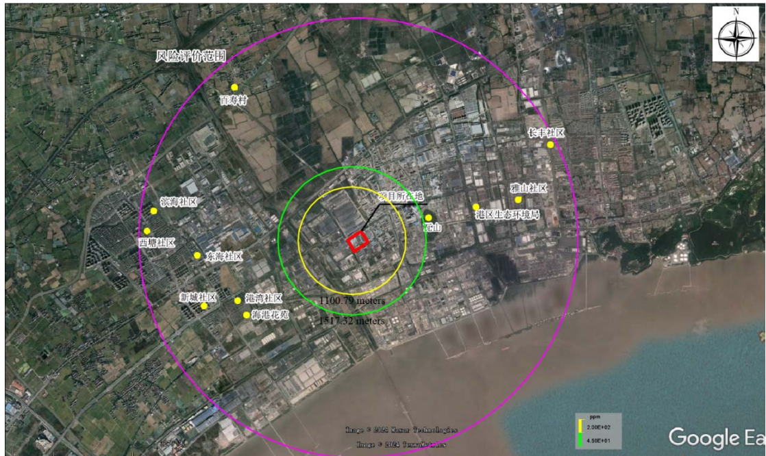
图 6.8-8 环氧乙烷球罐输送管道泄漏事故最不利气象条件下环氧乙烷扩散预测结果图
