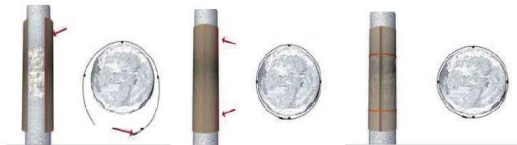
图 3.6.3-1 玻纤套筒施工
