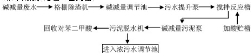
图 2.3-7 企业目前碱减量废水处理工艺流程图
