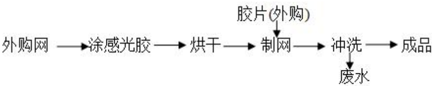
图 3.1-8 印花制网生产工艺流程
