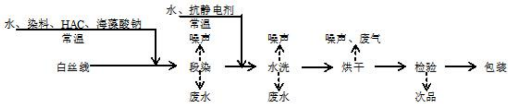
图 3.1-6 段染纱线生产工艺流程图
