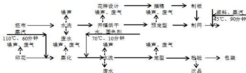
图 3.1-10 布印花生产工艺流程图
