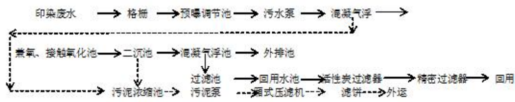
图 3.1-14 企业现有废水处理工艺流程图
