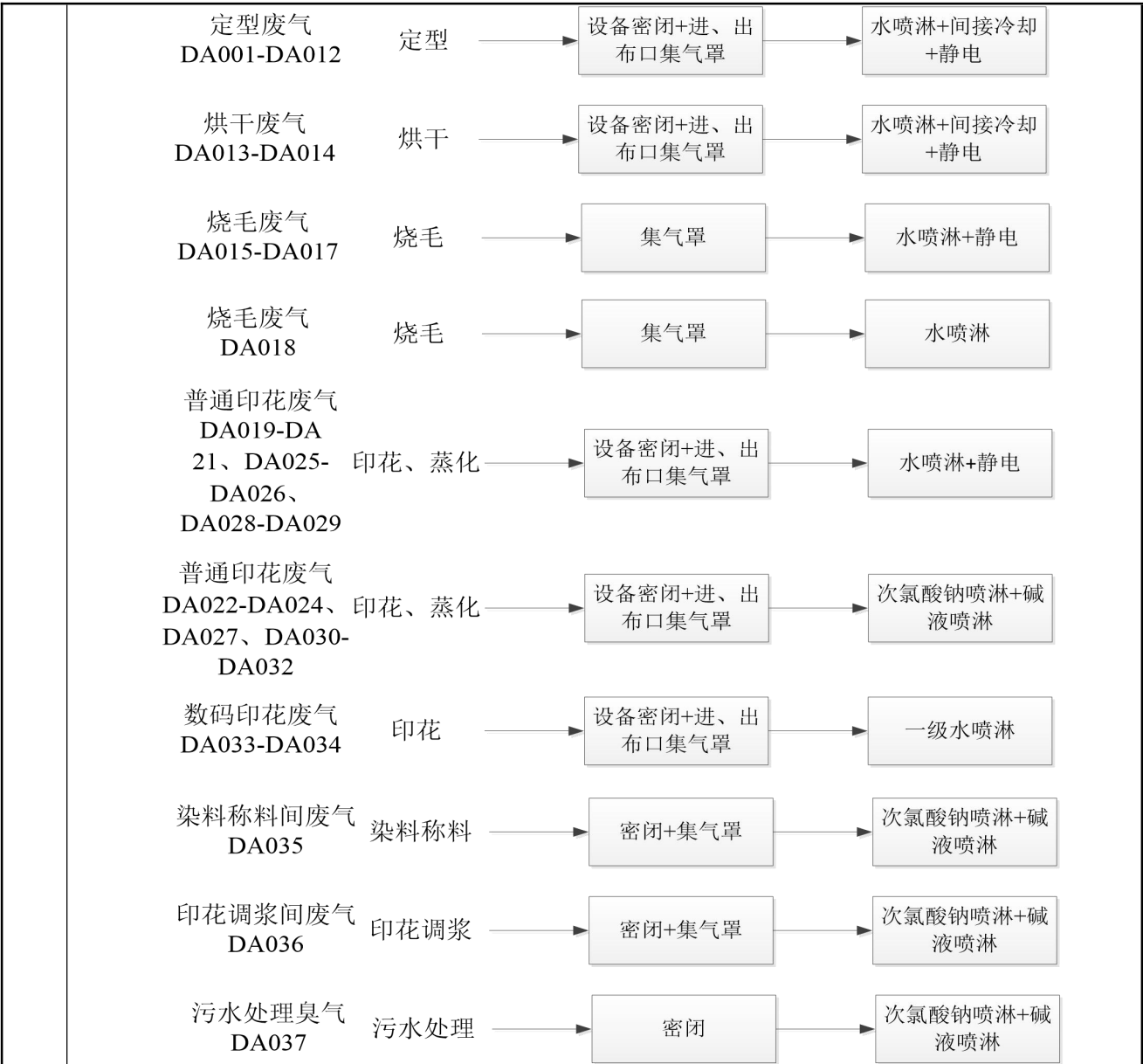
图 4.1-1 项目废气处理流程图
