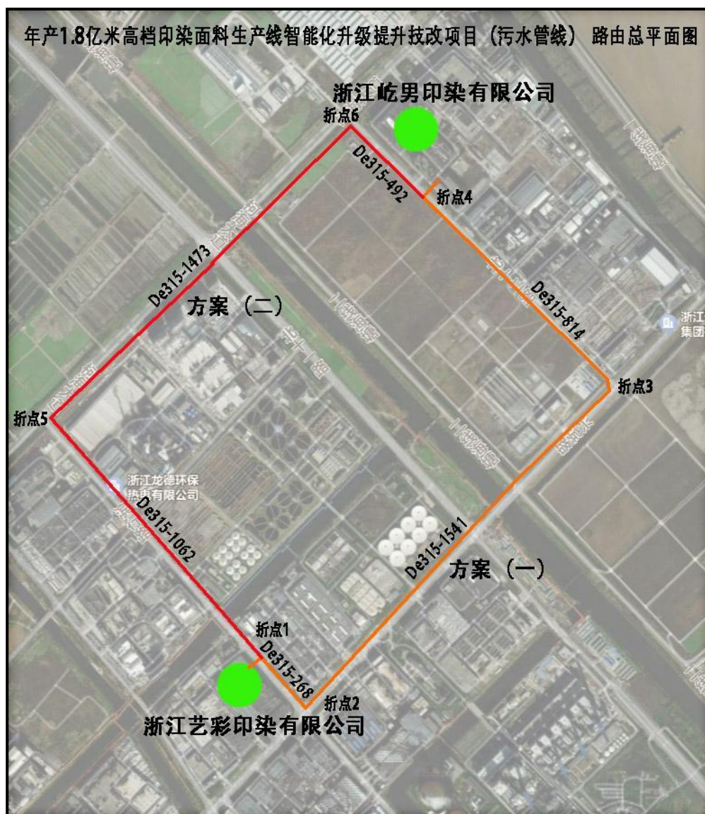
图 4.2-1 污水管路由选址方案比较图
