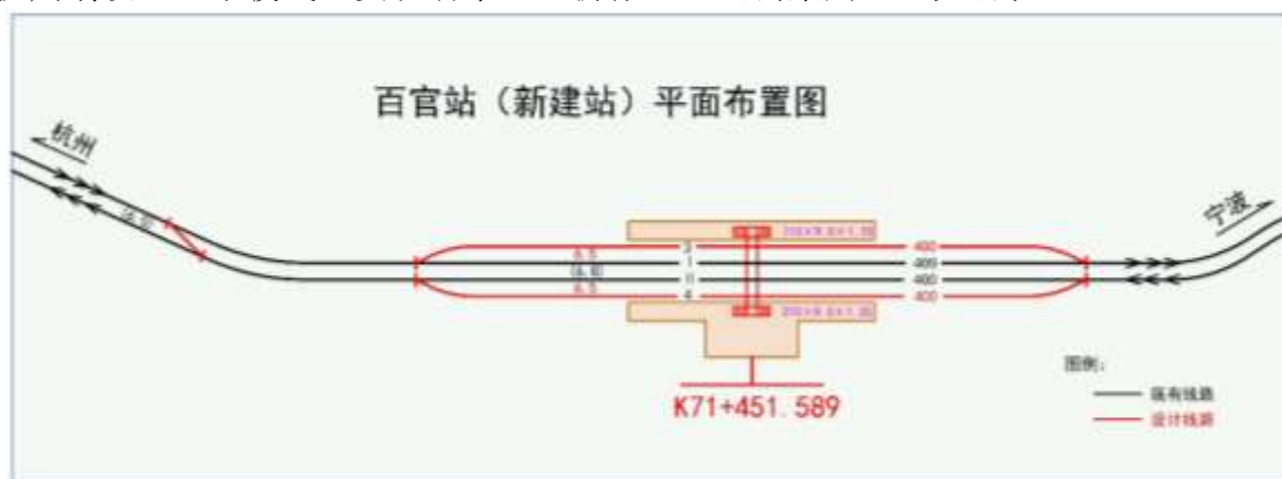
图 1-3 百官站平面布置示意图
