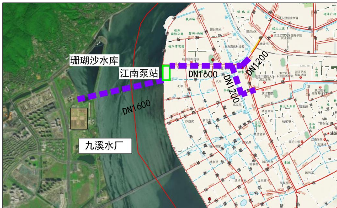
图 5-9 九溪水厂过江通道工程系统图
