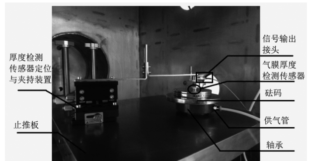
图 10 轴承静态性能检测装置
