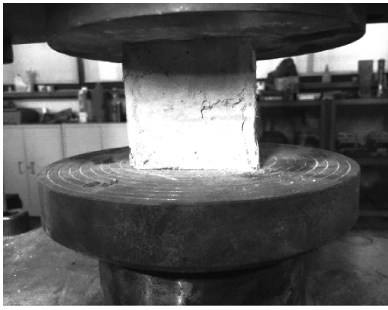
图 10 UHTCC 试块受压破坏模式
