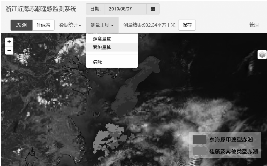
图 6 赤潮面积量测 Fig.6 HABs area measurement
