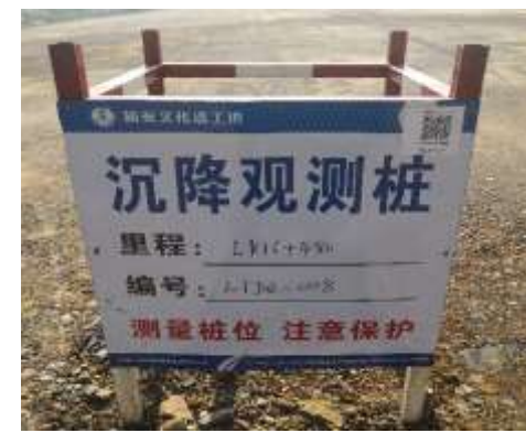
软基路段沉降观测桩
