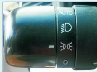
个灯光控制开关，逐一查看仪表盘上显示的灯光符号，如遇故障立即进行检修或更换。
