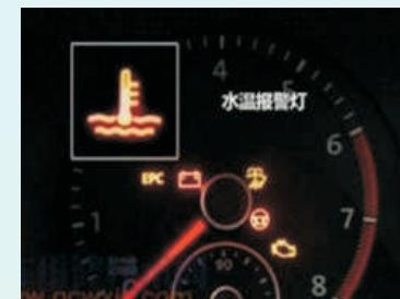
打开水箱盖检查水位，再给水箱加水。
