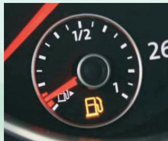
车辆在没有油之前，仪表盘上油箱信号灯会亮起。建议关闭车上的空调、收音机等电器，以降低油耗，同时尽快找到加油站。
