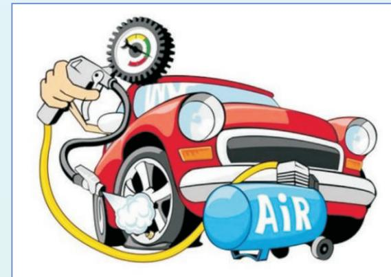
发动汽车查看仪表盘是否有胎压故障显示，有条件的可通过气压表检查，一般轿车的正常胎压范围为2.3-2.5bar左右、货车4.7-4.8bar，载重越高所需气压越大，具体可查看用户手册中厂家推荐值。
