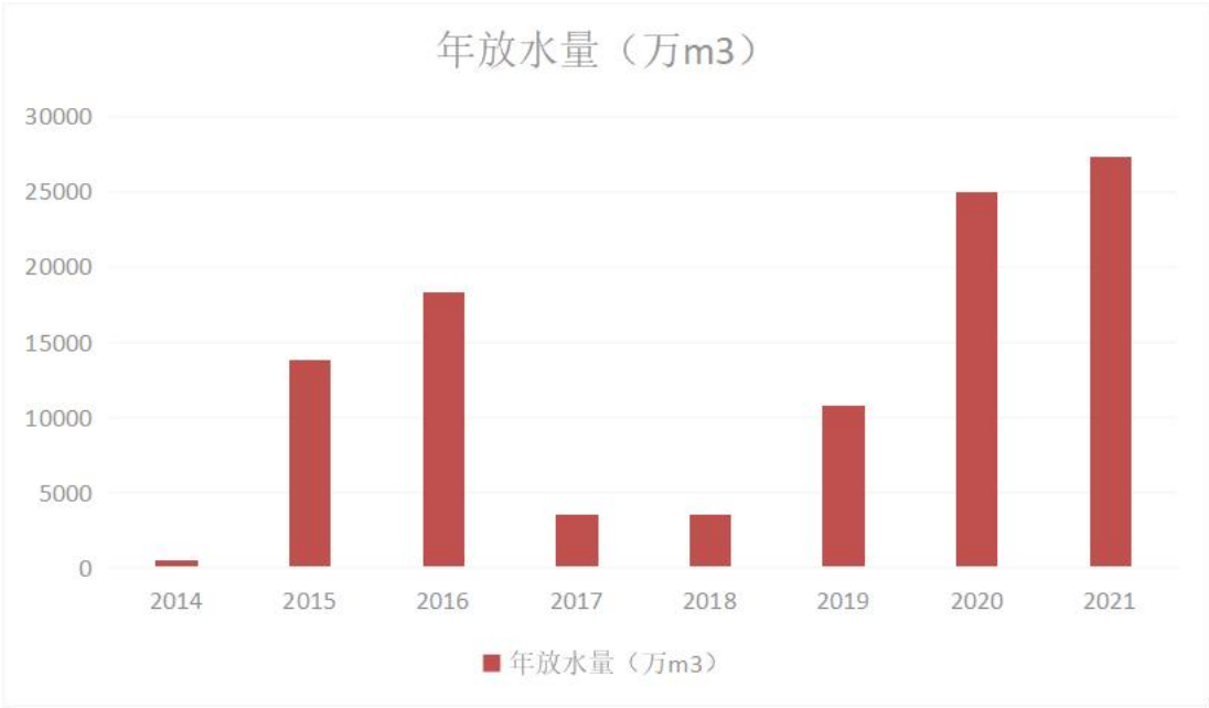
平湖塘延伸拓浚工程独山排涝闸历年排涝水量
