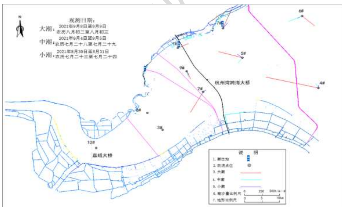
图 4.10-9 各测站净输沙矢量图
