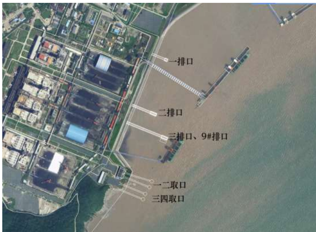
图 3.2-3 电厂现有循环水排水布置示意图
