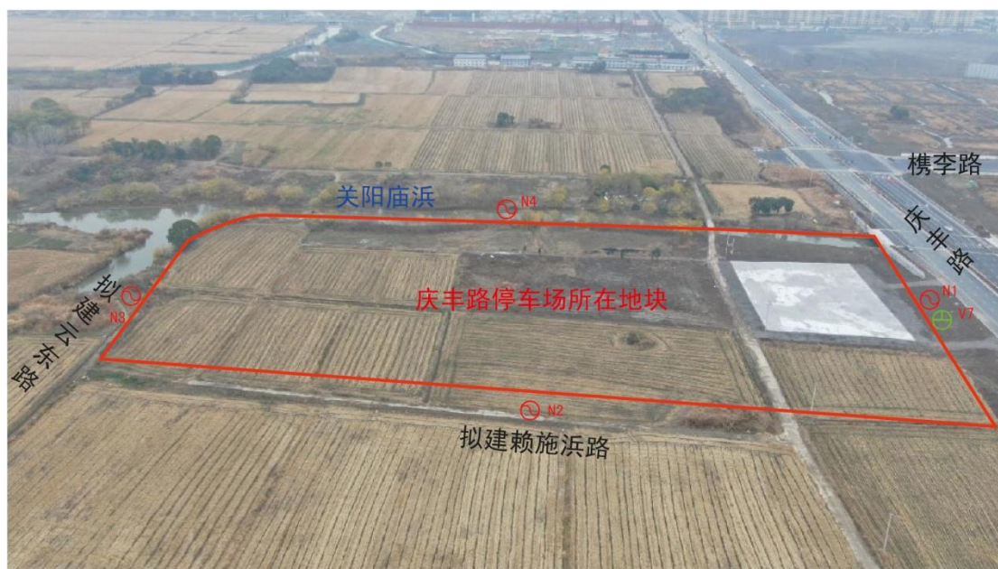
图 5.4-1 庆丰路停车场场界噪声监测布点示意图
