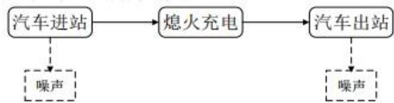
图 2-5 充电工艺流程及产污环节分析图
