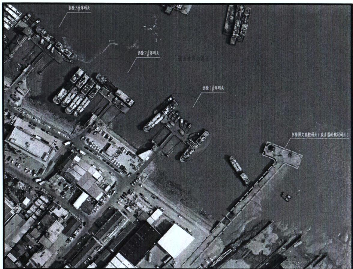
工程内容包括拆除礁山渔港西港区现有高桩码头 1 座、浮码头 3 座；新建渔业码头 1 座，泊位总长 688m，共有 12 个泊位；新建工作船码头 1 座，泊位总长 83m，共有 2 个泊位；疏浚港池、停泊水域及航道等土方约 111.21 万  $m^3$ ；新建驻港综合管理用房、公共厕所、门卫房、变电所等建筑物，总建筑面积 937  $m^2$ ；同时配套建设供
