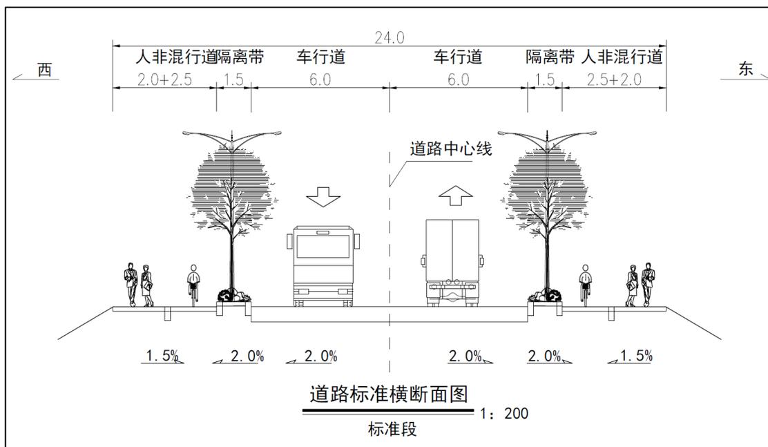
图 2.2-2 乐清湾港区外溪路建设工程标准横断面示意图
