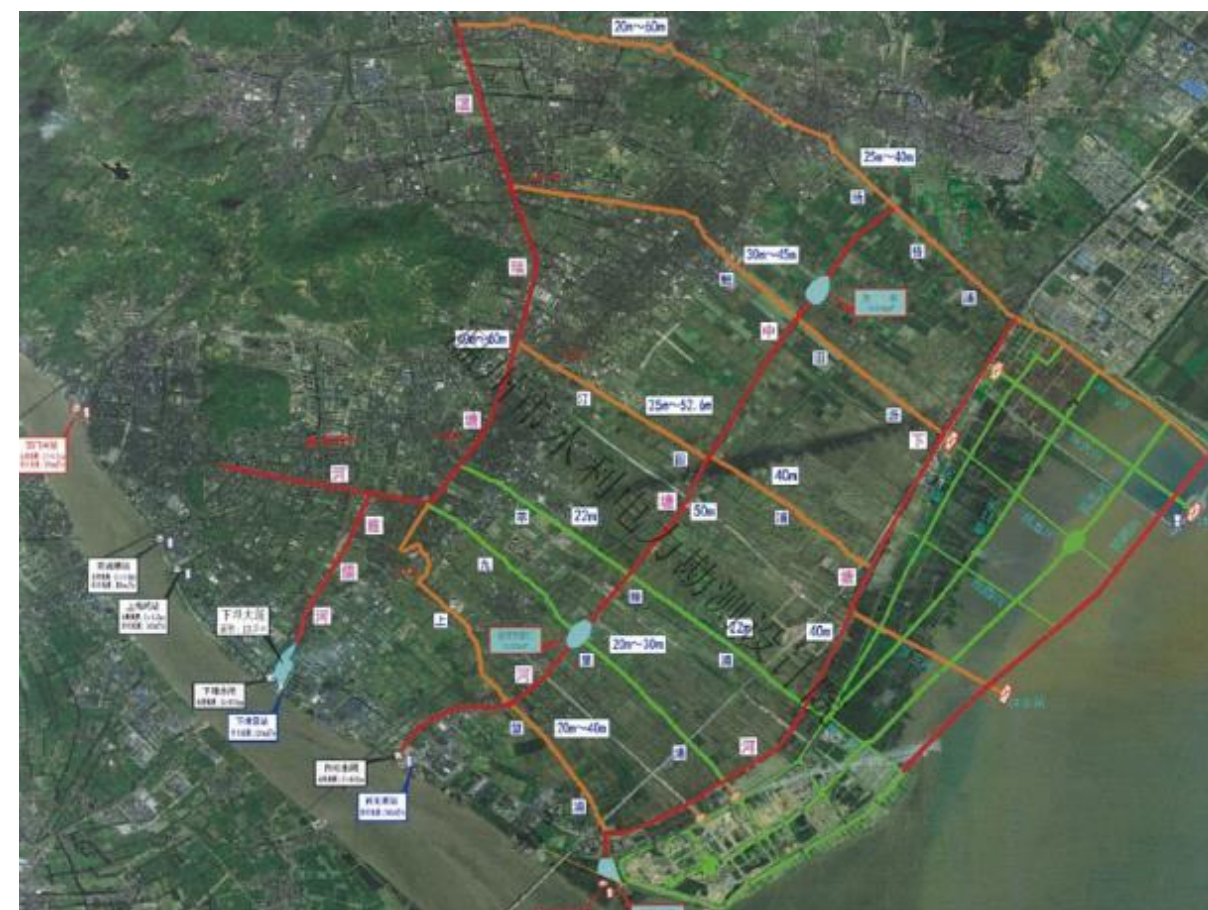
图 1.11 大河大通道强排方案平面布置图
