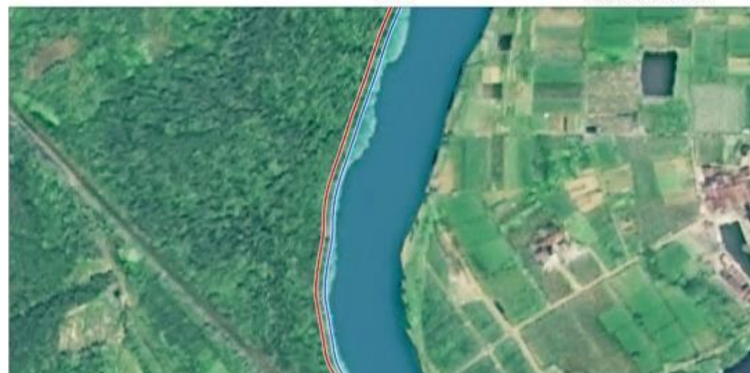
4.23 有岸滩河道控制线划定示意图
