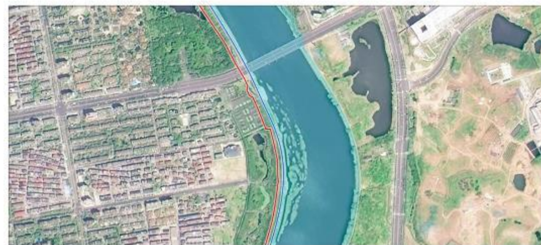
4.23 有岸滩河道控制线划定示意图
