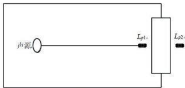
图 5.4-1 室内声源等效为室外声源图例
