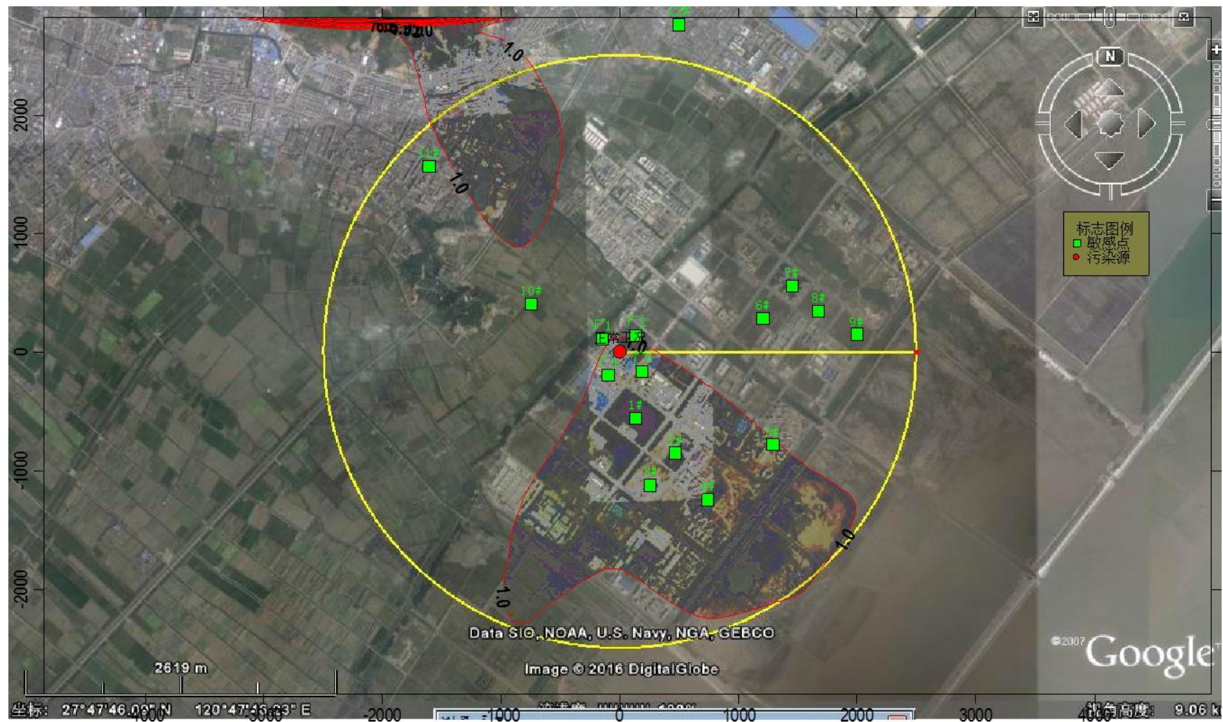
图 6.1-10 正常工况下 SO 2 最大地面日均浓度等值线分布图 (单位: \mu\text{g}/\text{m}^3 )
