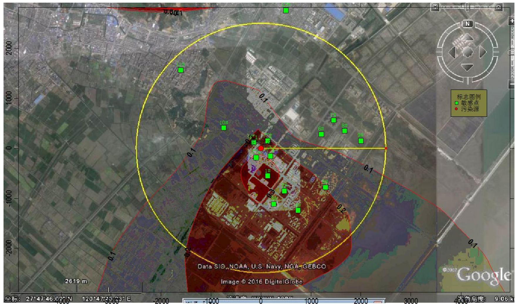
图 6.1-16 正常工况下 SO 2 最大地面年均浓度等值线分布图 (单位: µg/m 3 )
