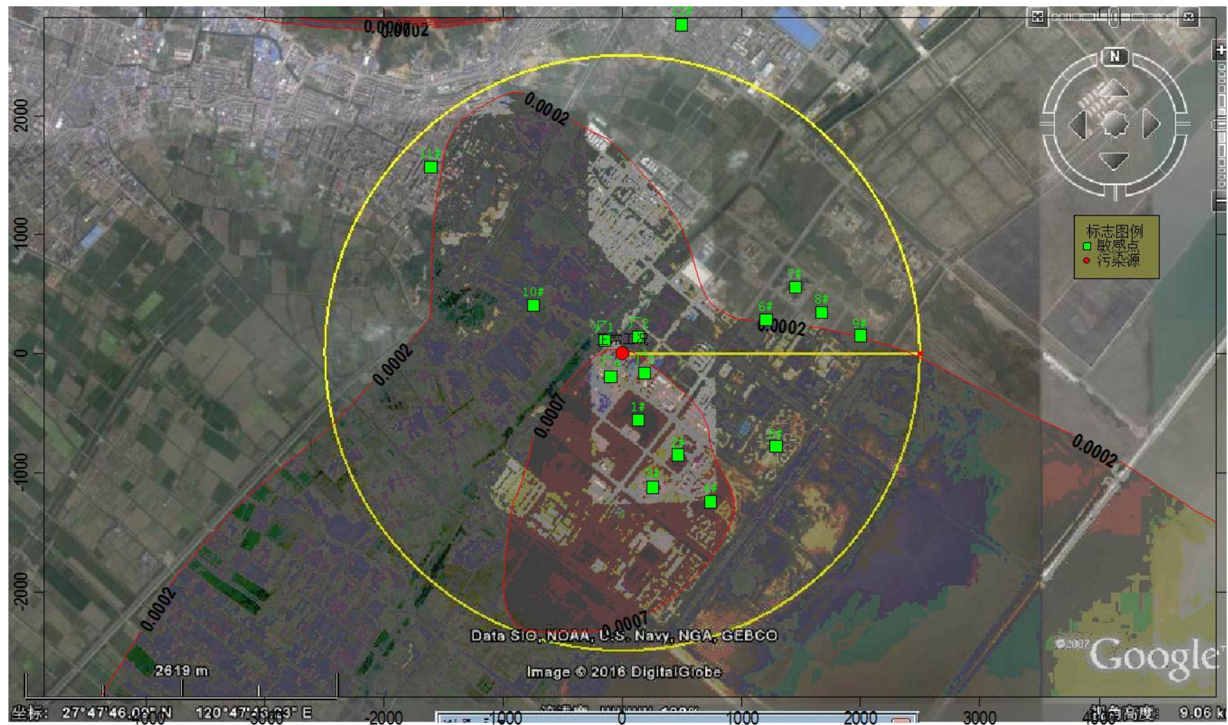
图 6.1-20 正常工况下二噁英最大地面年均浓度等值线分布图（单位： 10^{-4}\text{mg/m}^3 ）
