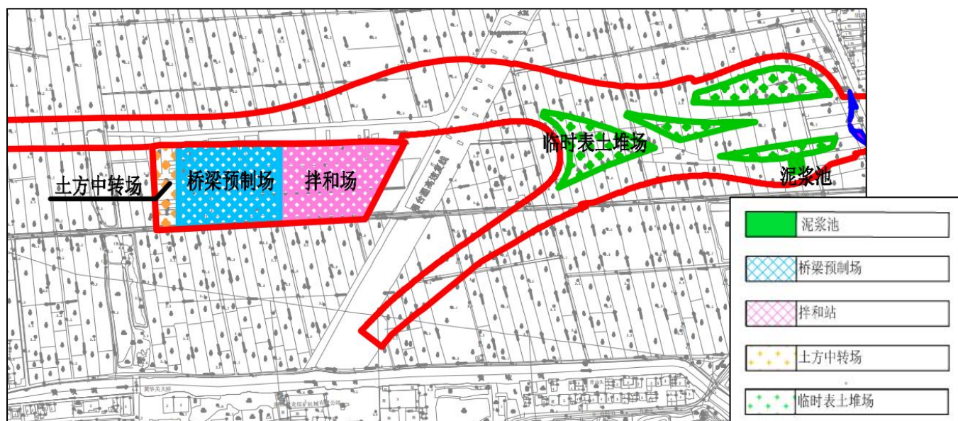
2#土方中转场、临时表土堆场、桥梁预制场、混凝土拌合站
