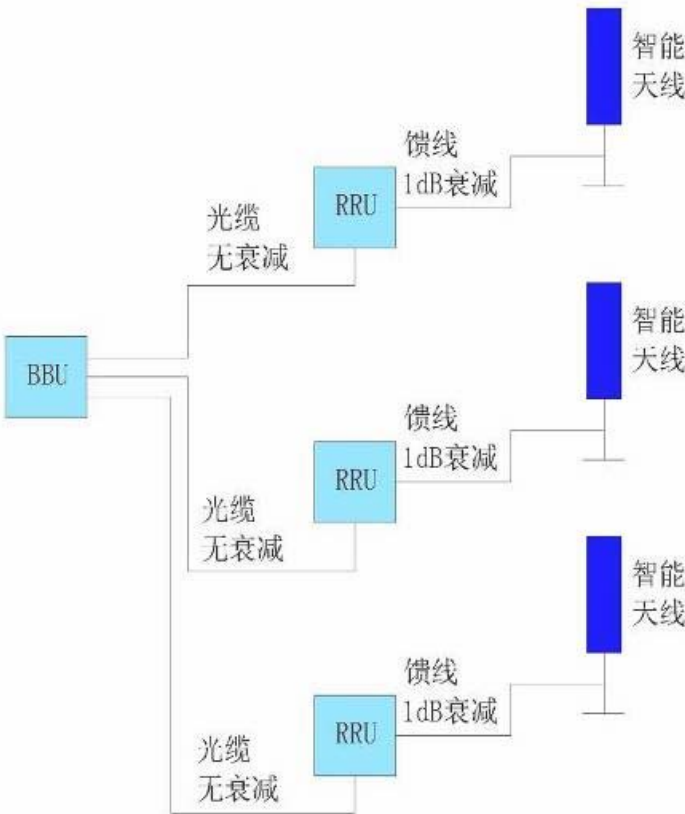
图3-3 TD-SCDMA基站主要设备及流程示意图
