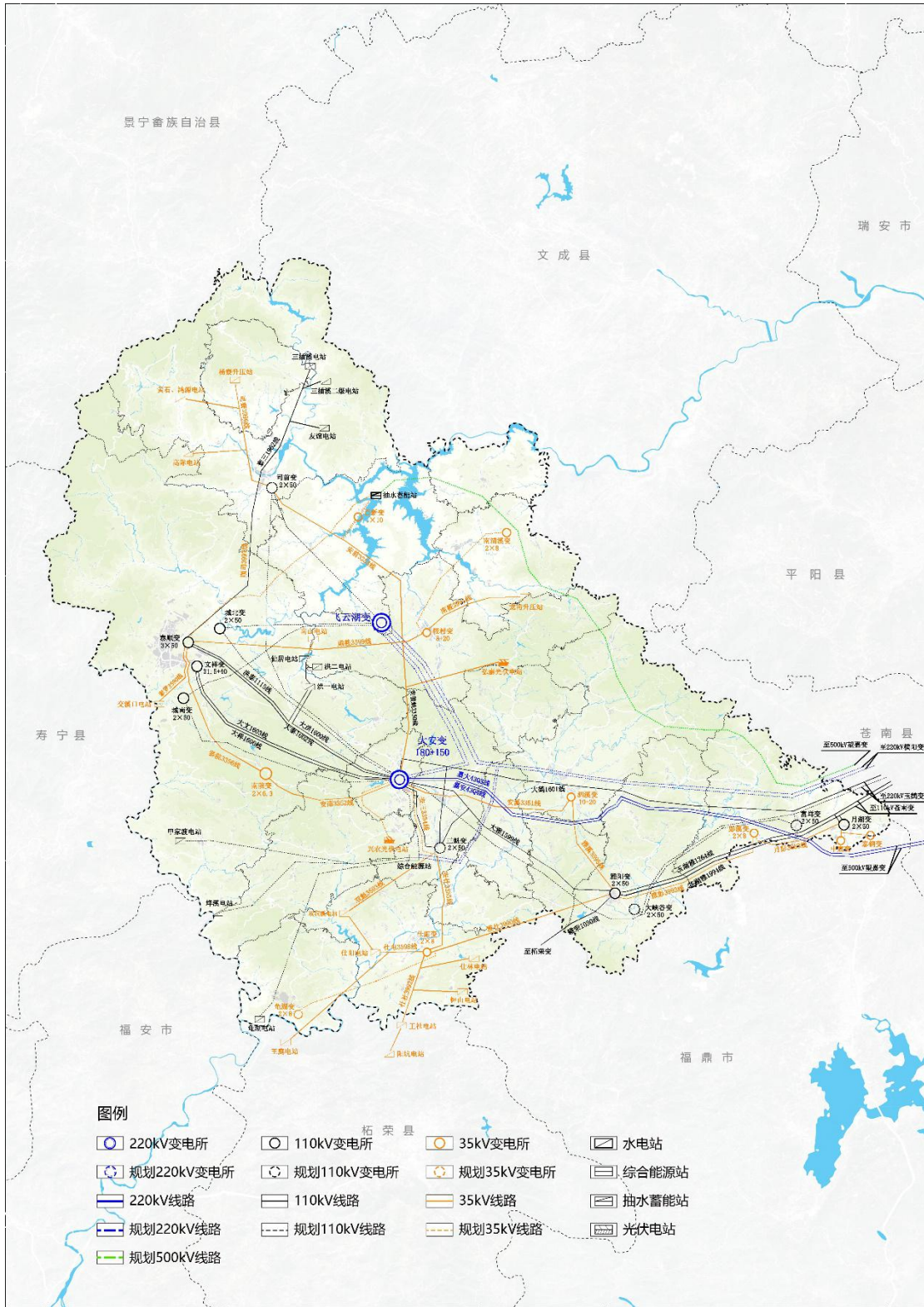
图 6-10 泰顺县 2035 年电力地理接线图
