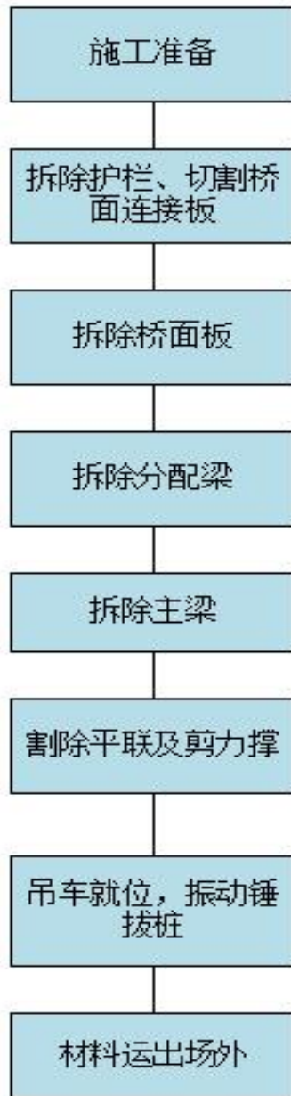
图 3.2.4-25 钢栈桥拆除工艺流程图
