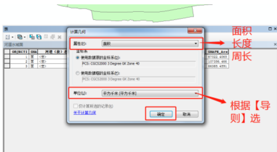
图 3.2-9 GIS 软件水域面积计算（示例）
