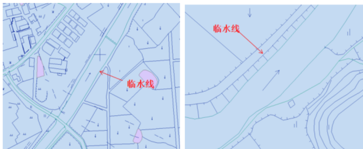
图 3.2-2 地形图上河道临水线的绘制（示例）
