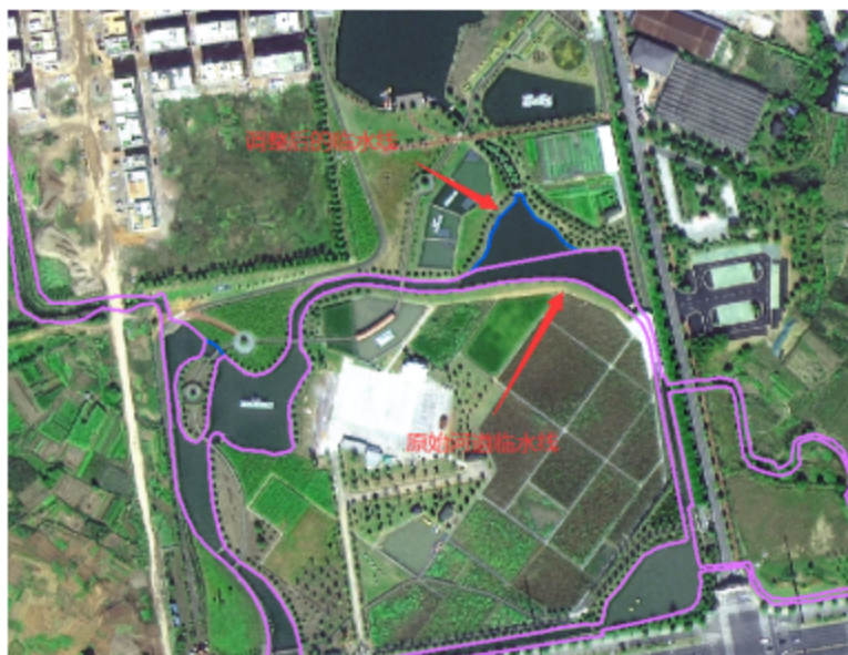
图 3.2-3 通过影像图对河道临水线进行调整（示例）
