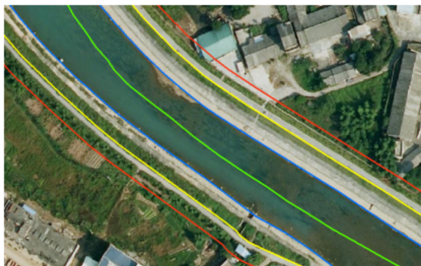
图 3.2-8 河道中心线判绘——绿色线条（示例）
