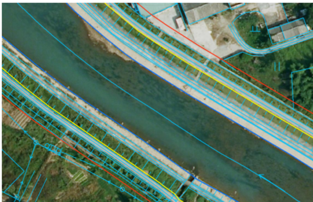
图 3.2-5 有堤防河道管线判绘——红色线（示例）
