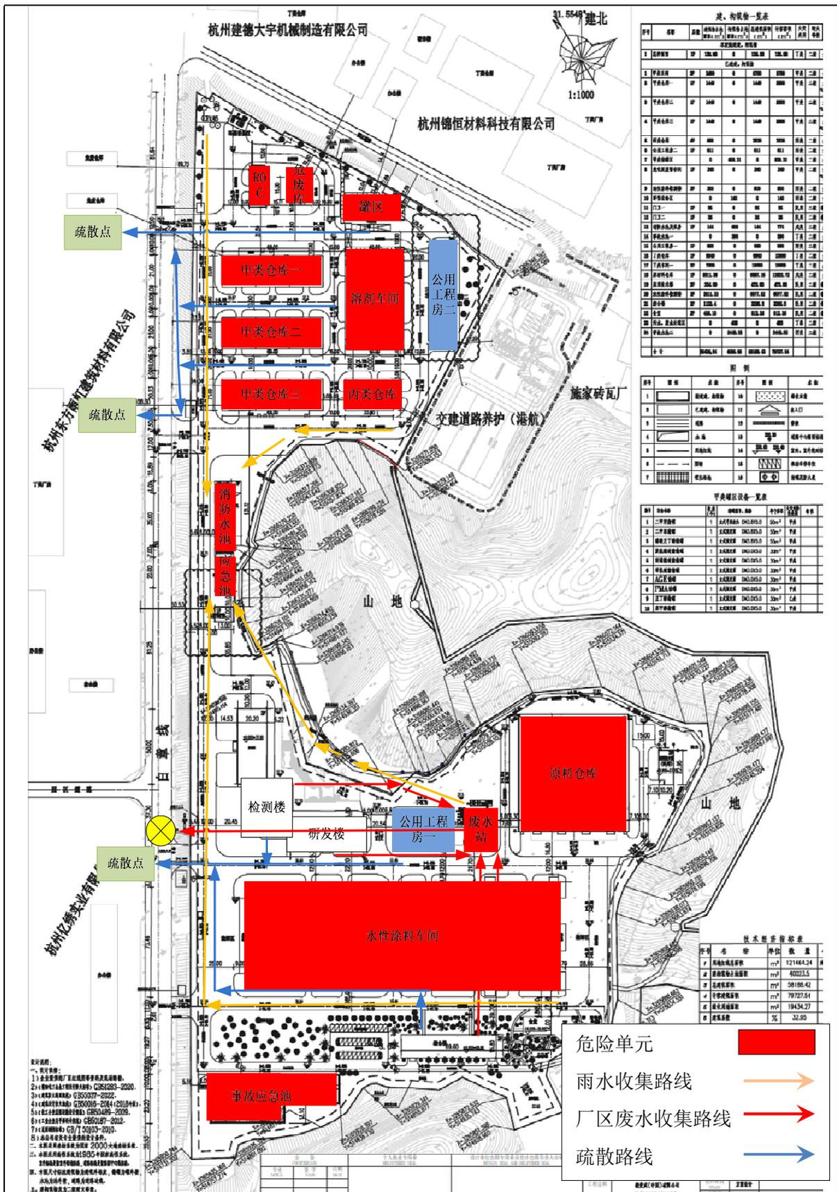
图 3 企业危险单元分布、雨水收集路线、厂区废水收集路线、厂区疏散点布置图
