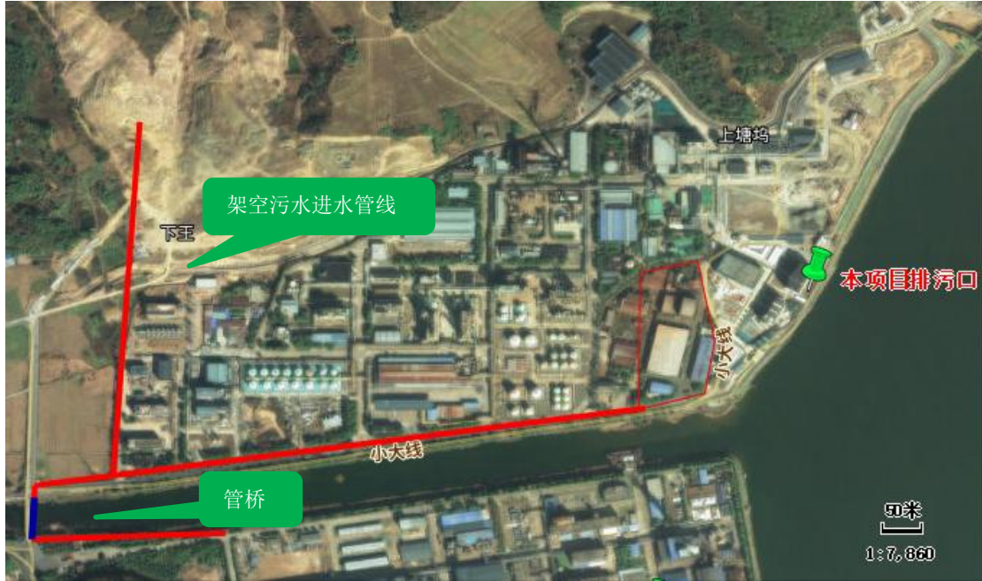
图 3.1-10 厂区外污水进水管线路由方案
