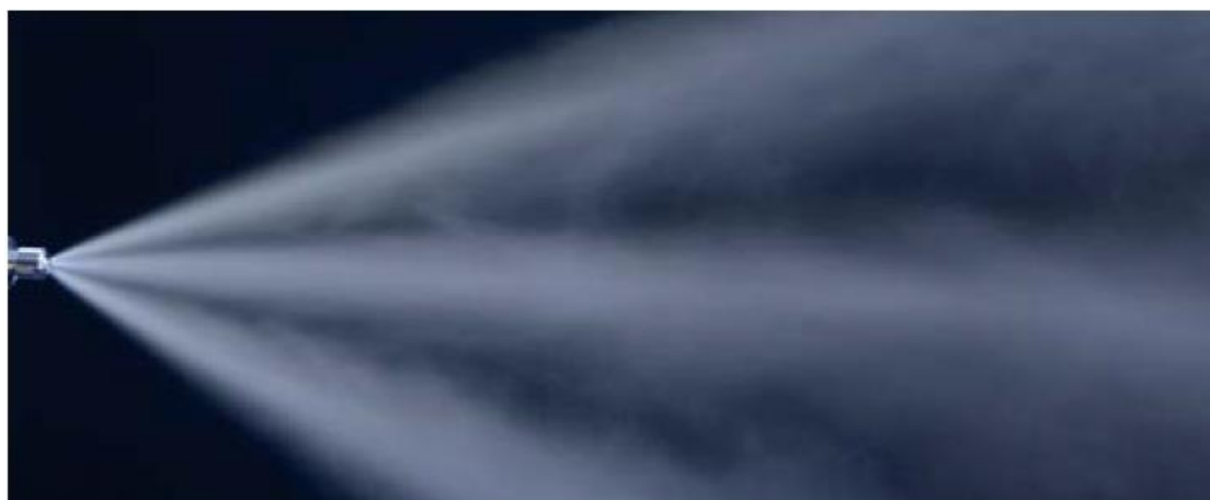
图 7.1-4 双流体雾化喷枪的喷射形状图
