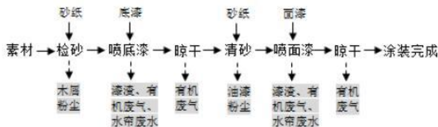
图 2-6 项目板式家具、软体家具的木质框架涂装工艺流程图
