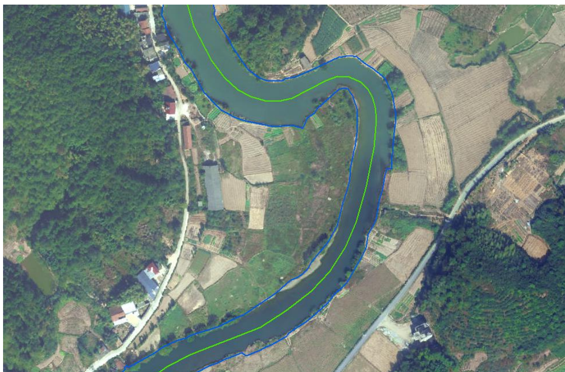
图 2.3-1 河道中心线提取（绿色线）
