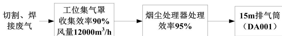
图 6.1-1 切割、焊接废气处理工艺示意图
