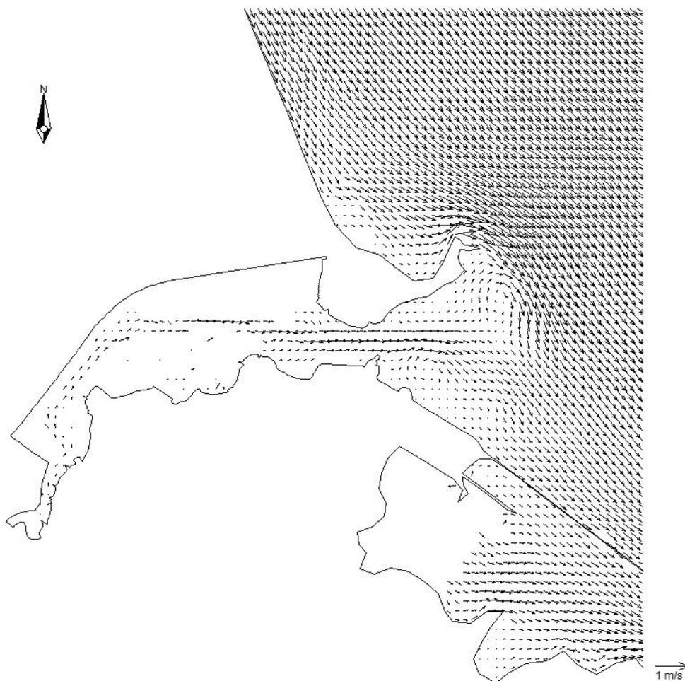
图 5.1-10 (b) 工程区附近大潮落急流矢图
