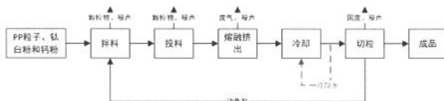
图 1-3 改性粒子生产工艺流程和产物环节图
