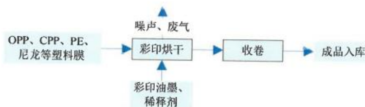
图 4-3 本项目印刷膜生产工艺流程图
