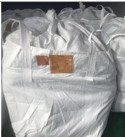
危险废物吨袋暂存且贴有明显标识
