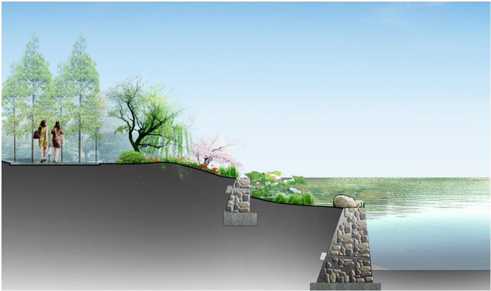
图 8-5 梯形浆砌石驳岸断面示意图
