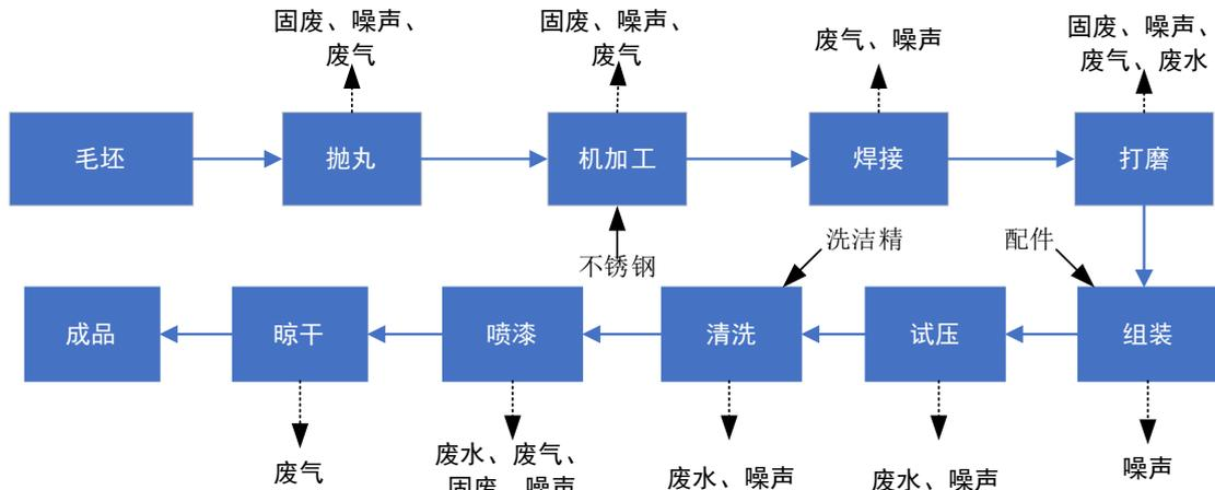
图 2-2 生产流程图及产污节点图
