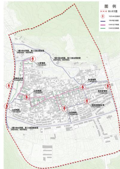
电力电信工程规划图
