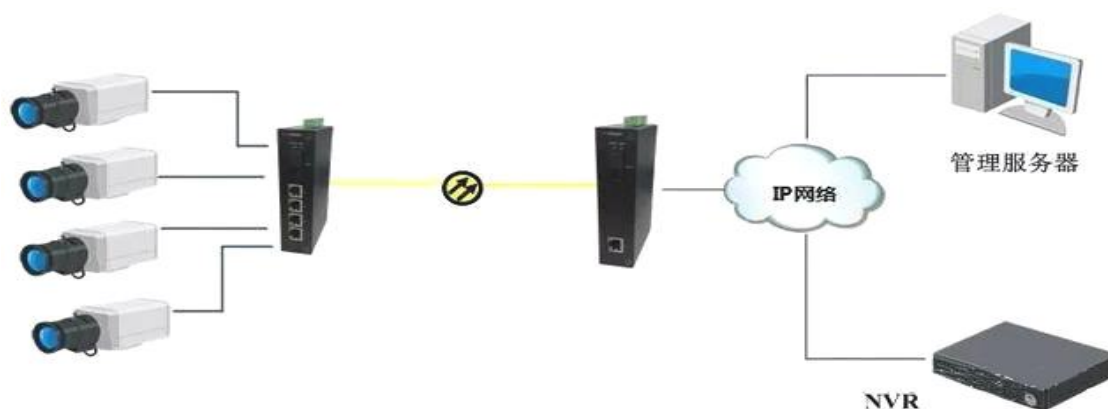
图4-6 乐清市森林防火监控系统传输示意图
