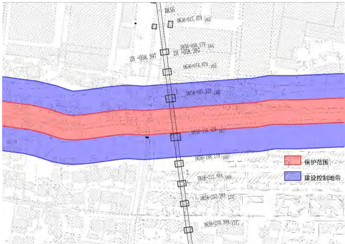
图 4.3-7 本工程萧绍海塘衙前段桥墩布置图
