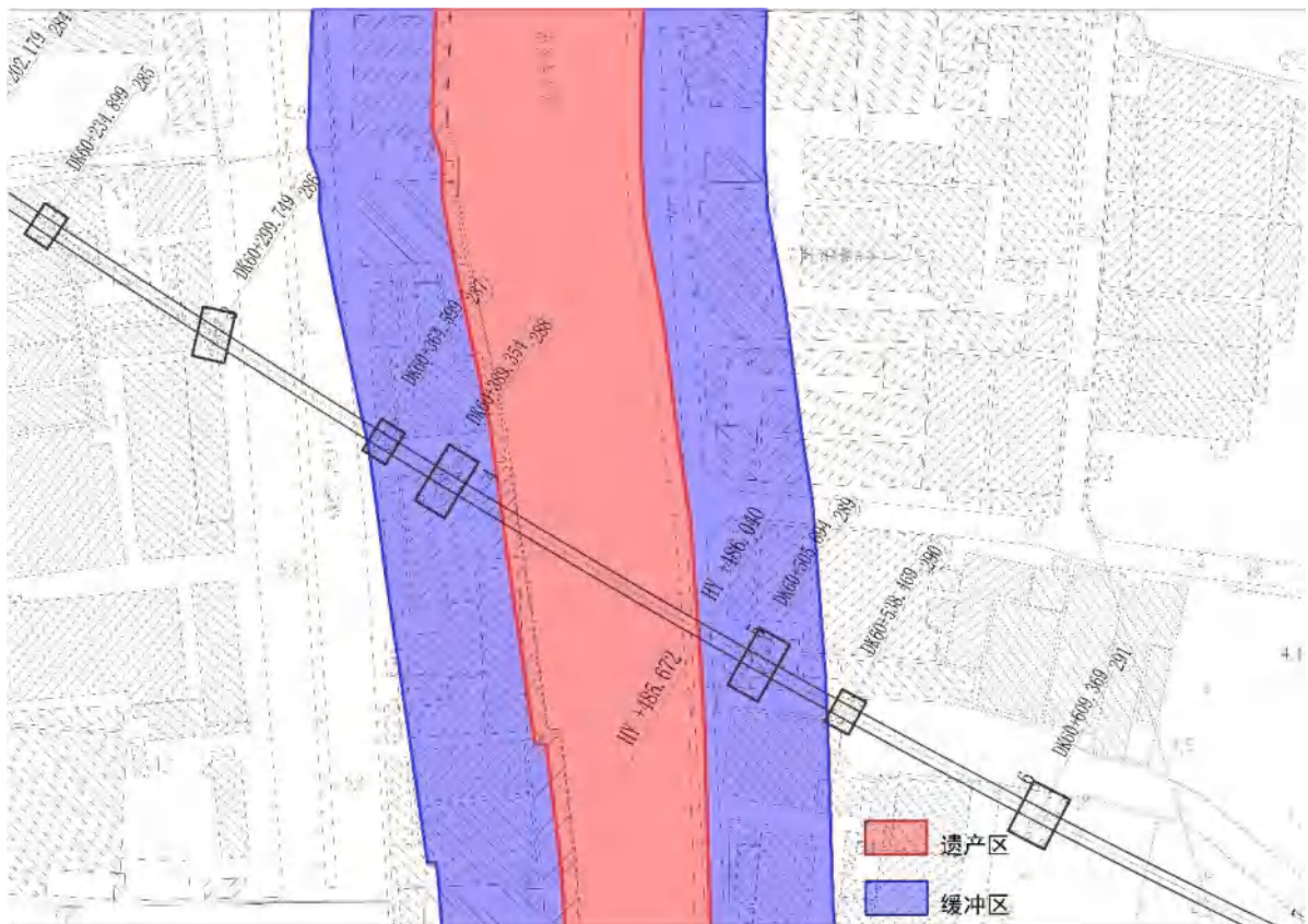
图 4.3-12 本工程大运河柯桥段桥墩布置图
