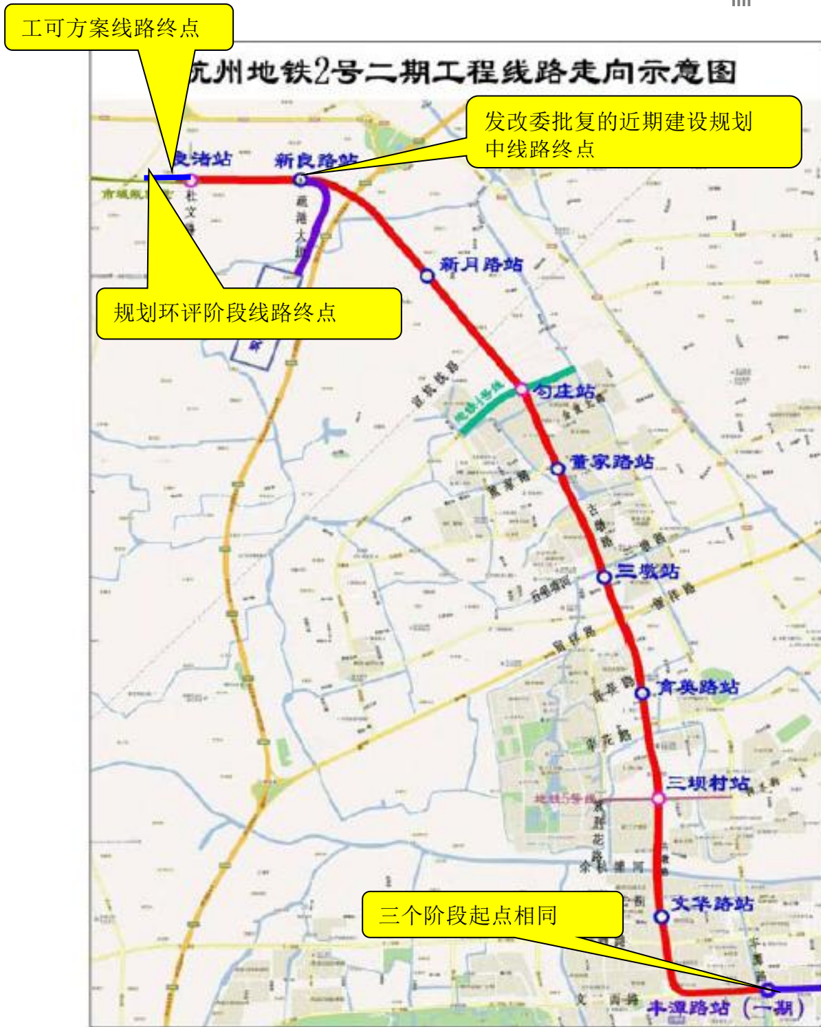
图 2.6-1 工可、规划环评、国家发改委批复的建设规划三阶段工程范围
