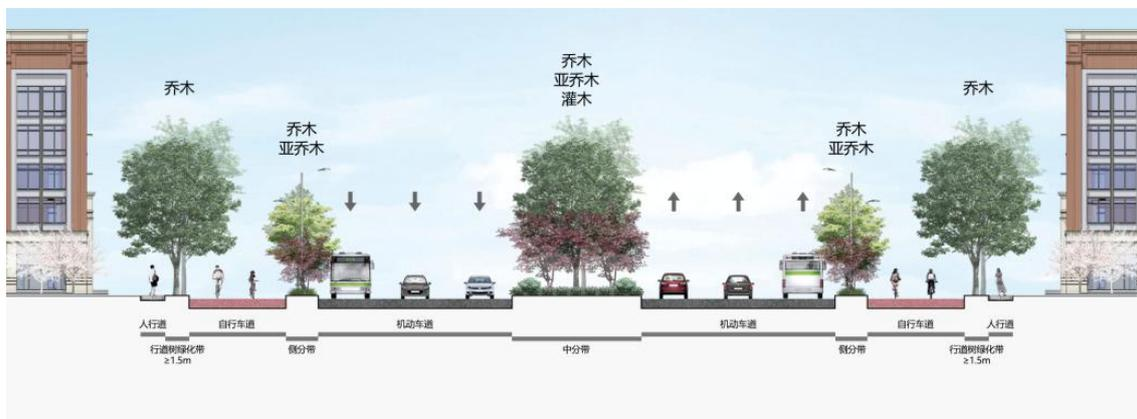
图 4-4 四板五带道路行道树种植示意
