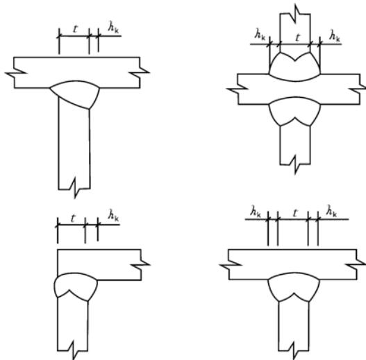
图 5.2.6 对接和角接组合焊缝
