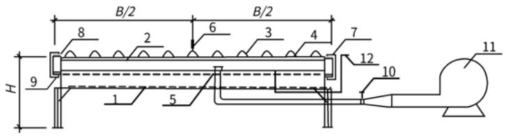
图 C.0.2 抗风揭性能检测装置示意
