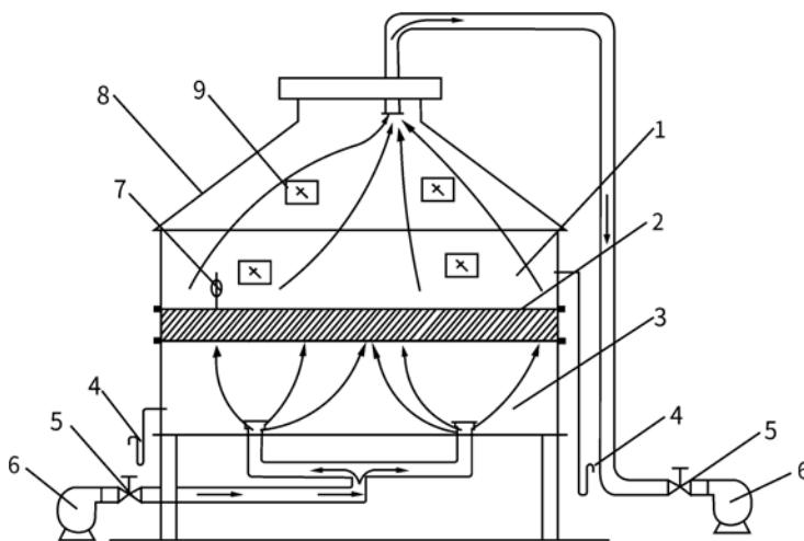
图 C. 0. 3 - 1 动态风荷载检测装置示意
