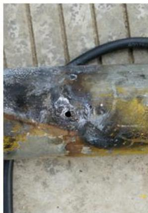
5.管道锈蚀：手工除锈后刷防锈漆、底漆、面漆。
