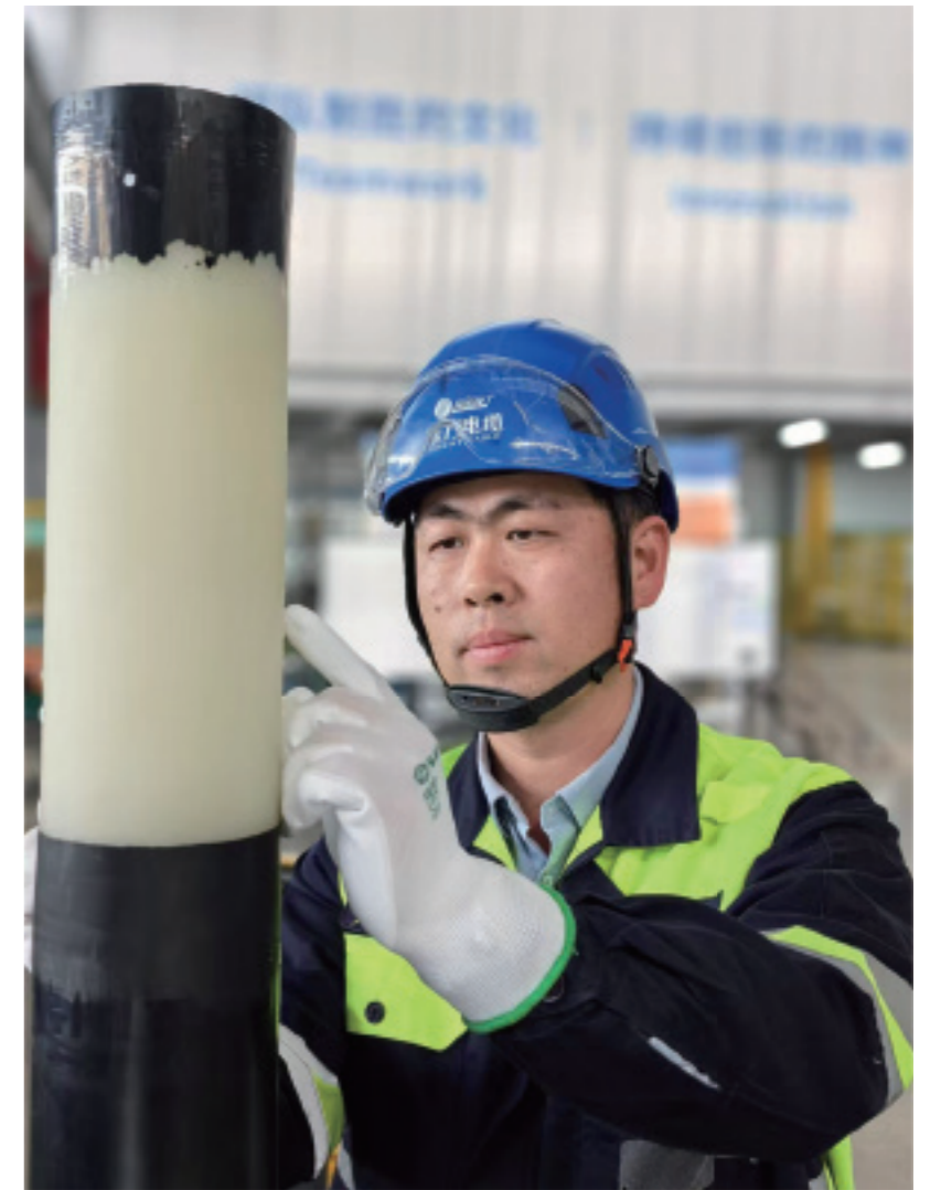
超高压海底电缆接头试验电缆处理
