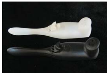
图7 蓝牙耳机的装配测试件,采用高精度 3D 打印机一次成型制作,材料质感与最终产品接近
