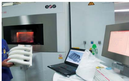
图5 使用尼龙粉末3D打印机打印出的汽车歧管,可用于200小时实际功能测试
