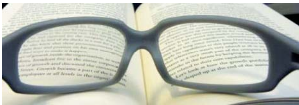
图8 眼镜的装配测试件,采用高分辨率 3D 打印机制作,使用具备韧性的打印材料
