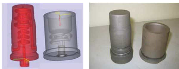
图10 使用金属 3D 打印机直接制作的带内部异型冷却流道的注塑模具
