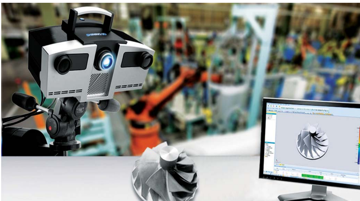
图 2 使用白光三维扫描仪快速、精准地获取叶轮的三维数字模型
