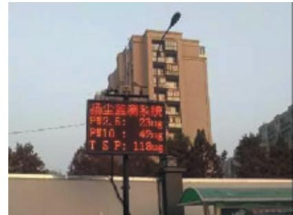
根据《杭州市大气污染防治规定》,符合标段的条件应按技术规范要求设置扬尘在线监测设施,并接入杭州市扬尘在线监测数据平台,实现工地扬尘等环保数据实时监测。
