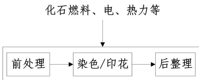
图 1 印染生产工艺流程图
