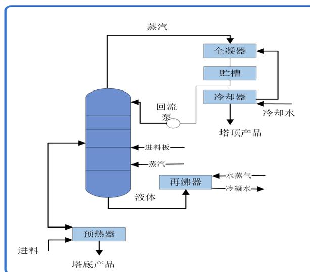
图 8 连续精馏流程示意图
