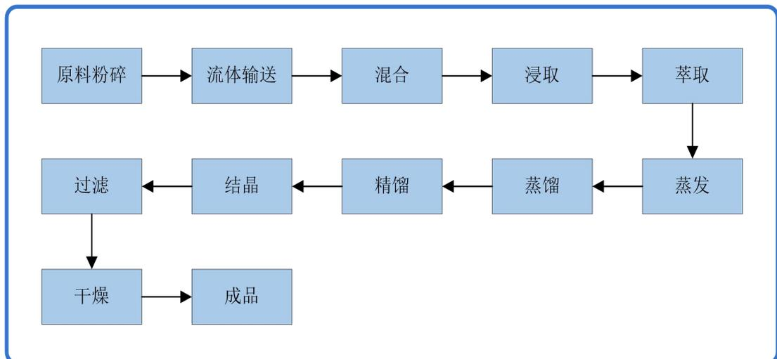
图 2 无机盐生产工艺过程图
