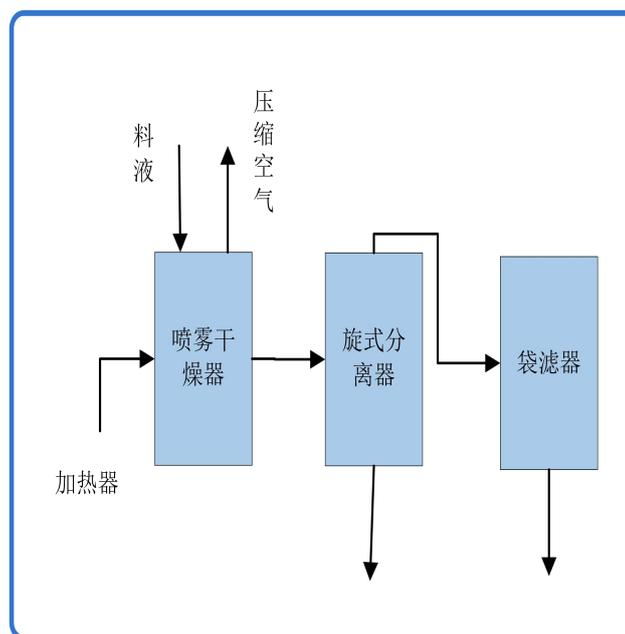
图 10 喷雾干燥流程示意图
