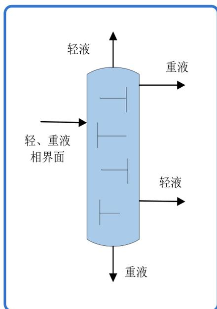
图 9 筛板塔萃取流程示意图
