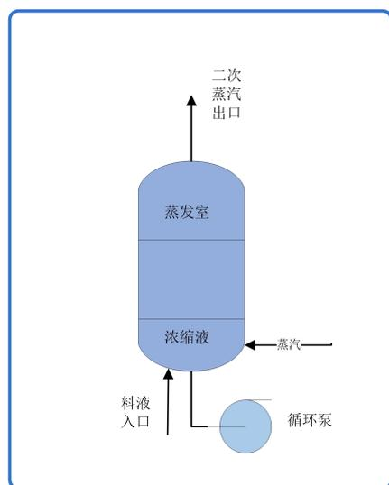
图 7 蒸发示意图
